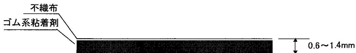
図-2 耐火テープの構造
