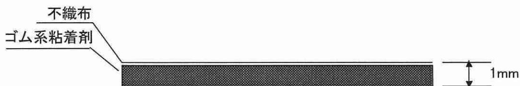
図－2 耐火テープの構造
