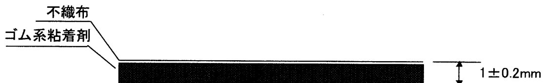
図－2 耐火テープの構造
