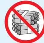
◎直管は段積みせず、結束単位で横置きに保管してください。
