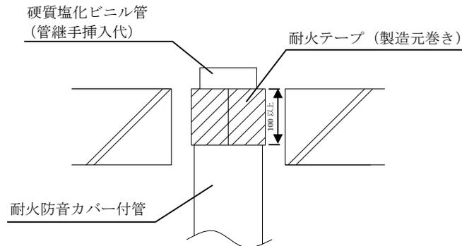
② 耐火テープが 100mm 以上埋設されない時は、耐火テープを現場で追加して巻き付け、100mm 以上埋設されるようにする。
