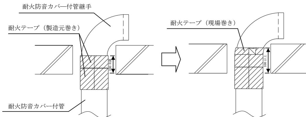
被覆材と被覆材との接合部（貫通部外）には、ジョイントテープを巻き付ける。
