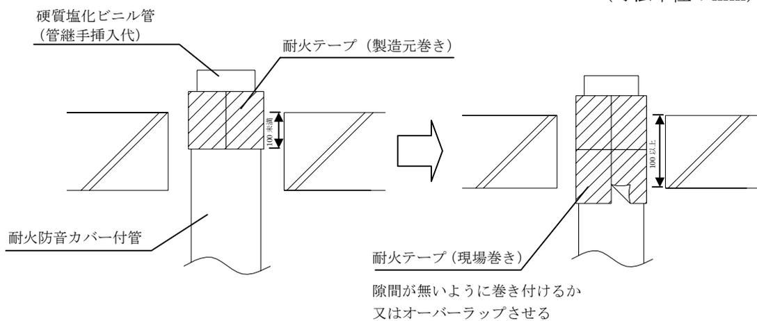
被覆材と被覆材との接合部 (貫通部外) には、ジョイントテープを巻き付ける。
